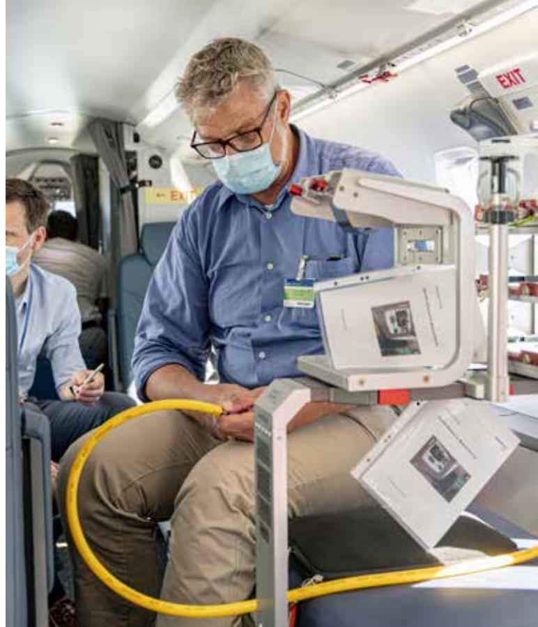
Inför flygplansleverans genomfördes, vid flygplansfabriken i Schweiz, samfunktionstester av flygplanets elektronik och den medicintekniska utrustningen.
