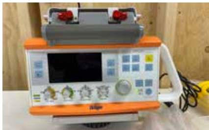
Ventilator (Dräger Oxylog 3000 plus)
